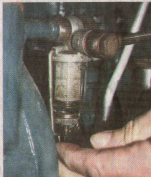
Ganz einfach: Im Handumdrehen wird der Dieselfilter ersetzt.
